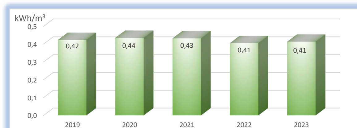
Graafik 8. ELEKTRIENERGIA TARBIMINE VEEPUHASTUSJAAMAS TOODETUD VEE ÜHIKU KOHTA AASTATEL 2019-2023, kWh/m 3
