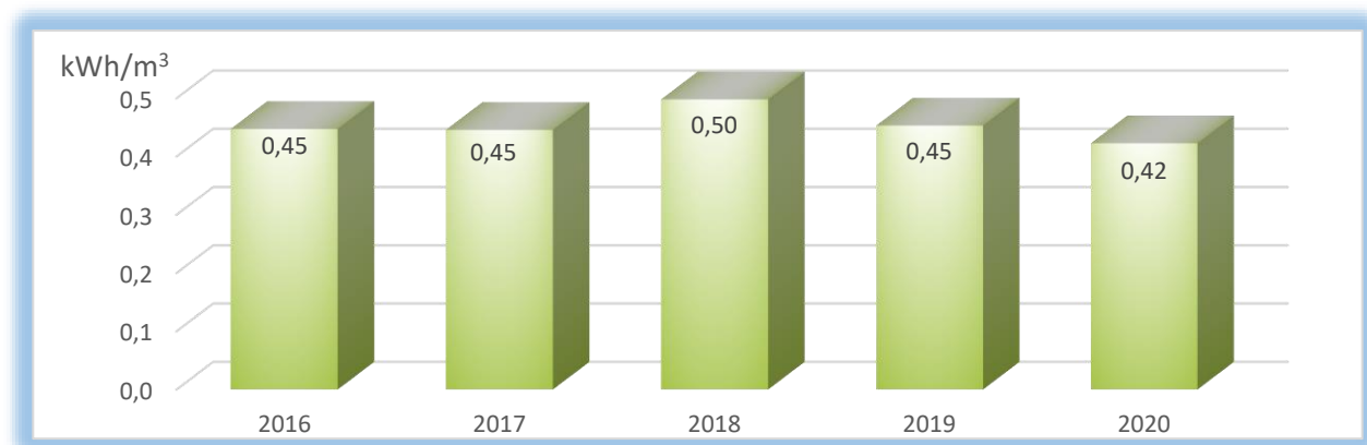
Graafik 8: ELEKTRIENERGIA TARBIMINE REOVEEPUHASTUSJAAMAS TOODETUD VEE ÜHIKU KOHTA AASTATEL 2016-2020, kWh/m 3
