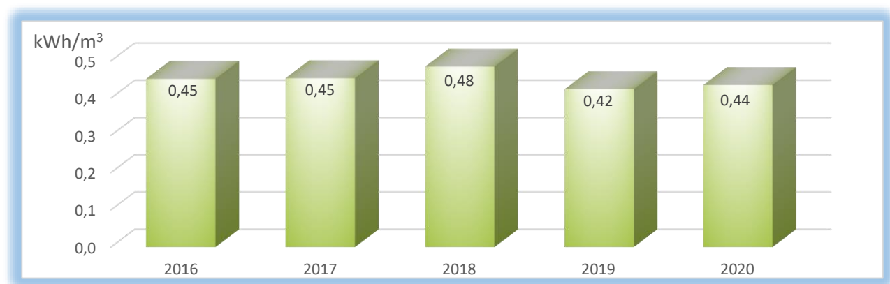
Graafik 7: ELEKTRIENERGIA TARBIMINE VEEPUHASTUSJAAMAS TOODETUD VEE ÜHIKU KOHTA AASTATEL 2016-2020, kWh/m 3
